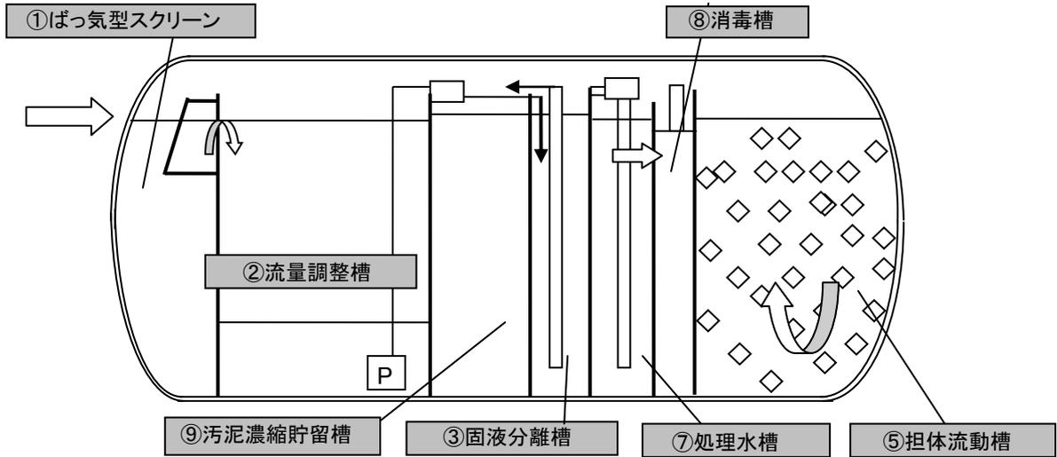
担体流動槽が流入側と反対側の鏡部に配置され、固液分離槽と担体流動槽の仕切板の間に第一ろ過槽、担体ろ過槽、処理水槽、消毒槽、放流(ポンプ)槽が配置されています。
