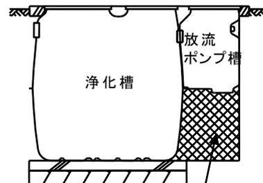
埋め戻しの際、放流ポンプ槽の底部および浄化槽とポンプ槽のすき間には十分土を入れてください。
