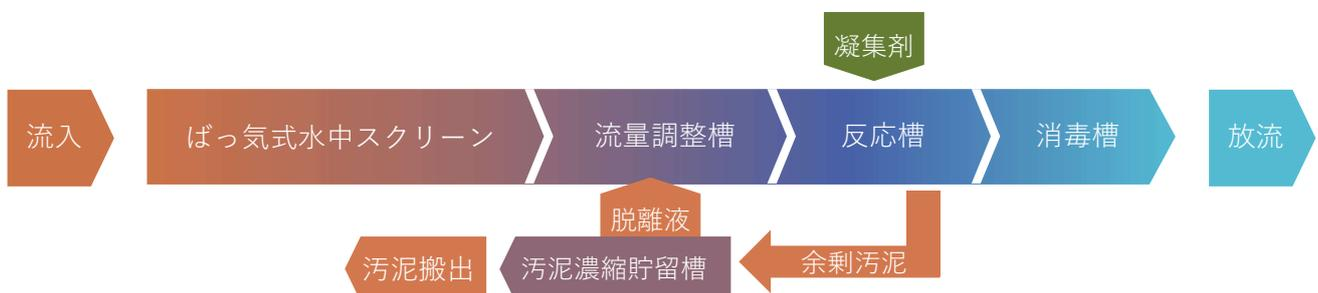
※51～500人槽の代表例。501人槽以上については汚泥濃縮貯留槽が汚泥濃縮槽と汚泥貯留槽に分割。
