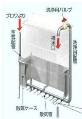
ブロウ運転中に洗浄用バルブを開けると槽内液により散気管内を洗浄できます。洗浄用バルブに電動弁を使用すれば散気管洗浄を自動化することも可能です。
