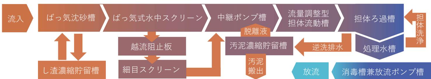
※流量調整タイプ (接触ばっ気方式) ・膜分離方式にも対応しております
